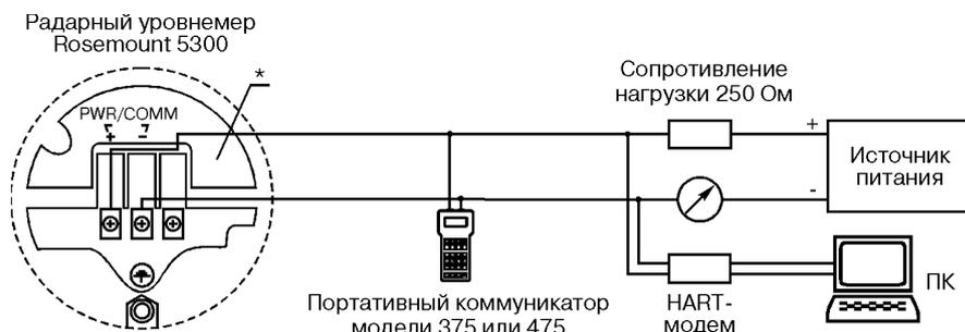
\* При температуре внутри корпуса около 60°C рекомендуется использовать проводку, рассчитанную как минимум на 90°C.
