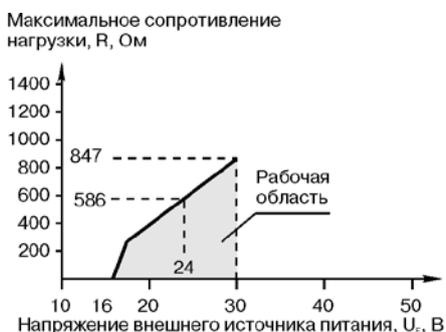
**Рис. 21. Диаграмма сопротивлений для уровнемера, сертифицированного на искробезопасность.**
