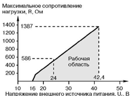
**Рис. 20. Диаграмма сопротивлений для уровнемера в безопасной зоне.**
