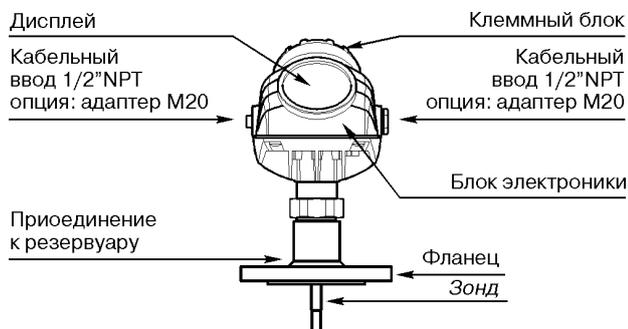
Рис.2. Конструкция уровнемера.
