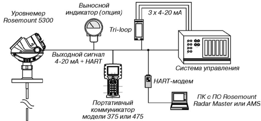
Рис.23. Интеграция в систему с использованием HART-протокола.
