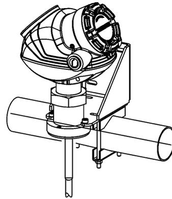
**Монтаж на трубу (горизонтальная труба).**
