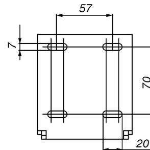
**Шаблон сверления отверстий для настенного монтажа.**
