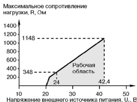
**Рис. 22. Диаграмма сопротивлений для уровнемера, сертифицированного на взрывобезопасность.**
