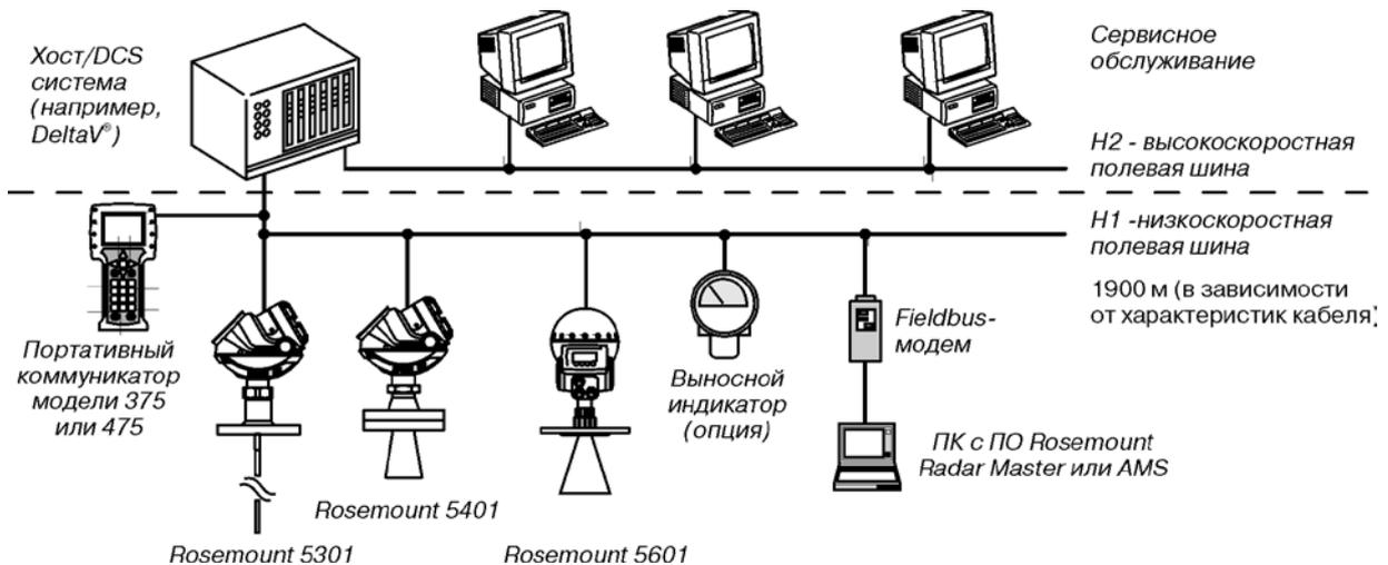
Рис.24. Интеграция в систему с использованием Foundation Fieldbus.
