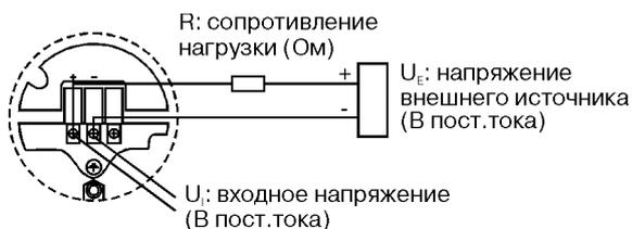
Входное напряжение  $U_i$  для HART составляет 16-42,4 В пост. тока (16-30 В пост. тока для искробезопасных приборов, и 20-42,4 В пост. тока для взрывобезопасных приборов). Максимальное сопротивление нагрузки и ограничения электропитания для типовых рабочих условий представлены на рис.20-22 и в табл. 10.
