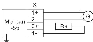
Для датчиков с выходным сигналом 4-20 мА
