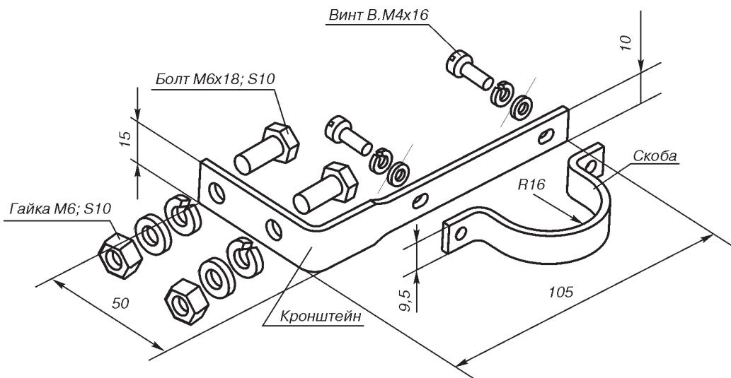
**Рис.5. Кронштейн крепления датчика к стене или опоре.**
