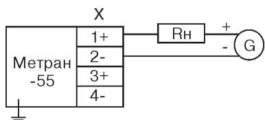
Вариант подключения нагрузки для датчика
