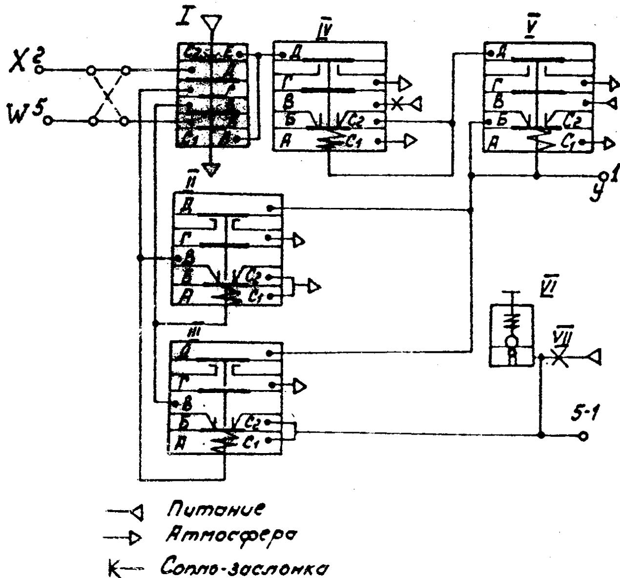
Рис. 1. Принципиальная схема регулятора ПР1.6-М1
