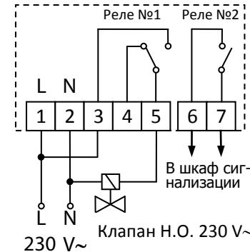
Рис.3 Схема подключения с нормально-открытым клапаном
