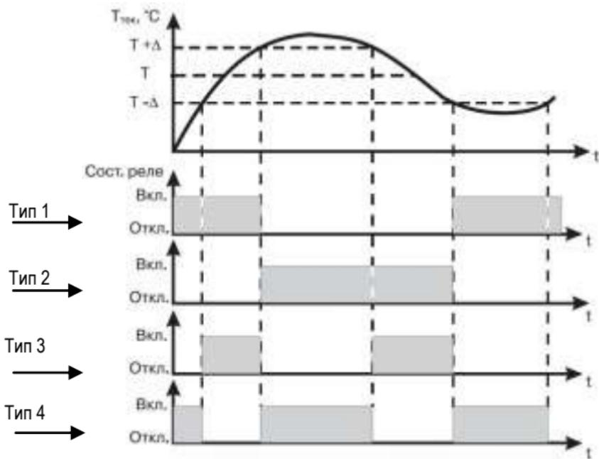
Рисунок 2 – Диаграммы работы выходного устройства «Нагрев» терморегулятора РАТАР-02У
