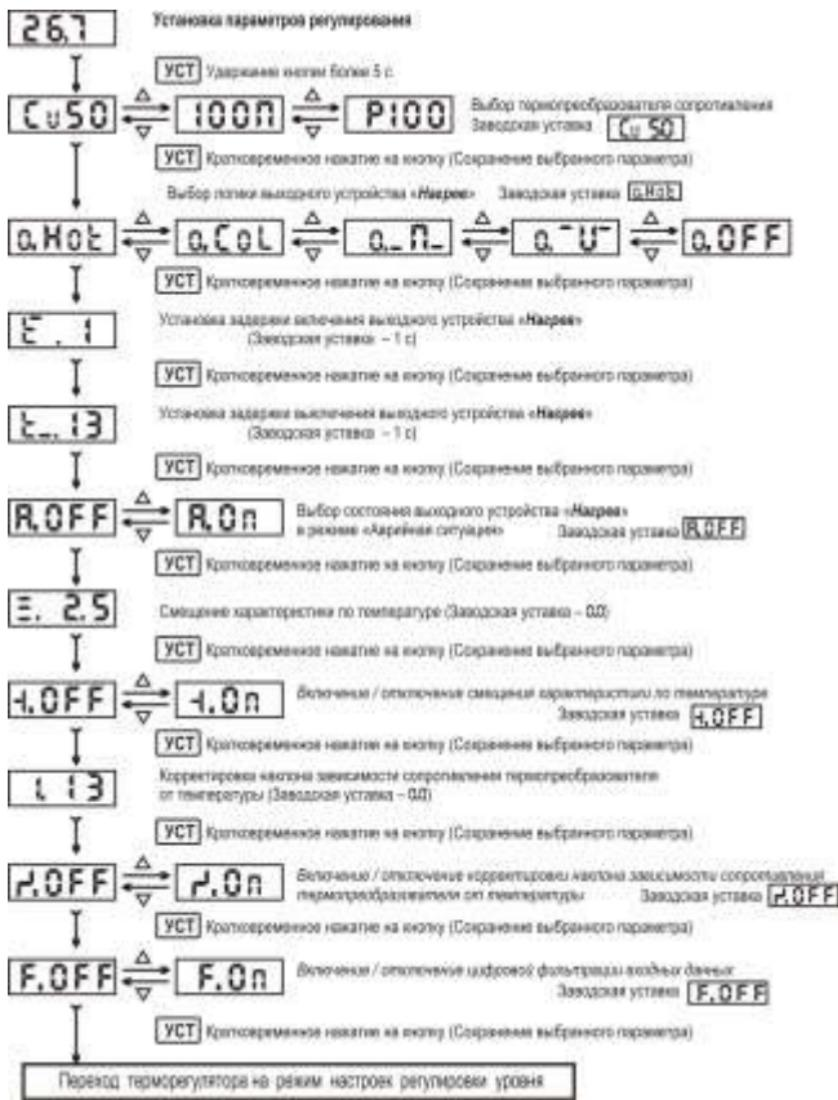
Рисунок 5 – Алгоритм программирования терморегулятора
