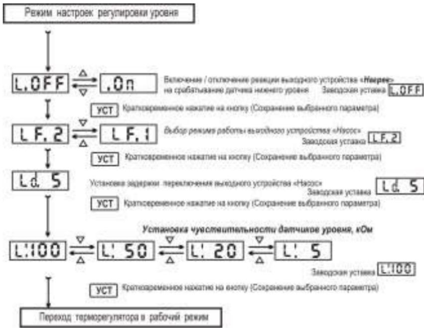
Рисунок 5 – Алгоритм программирования терморегулятора РАТАР-02У
