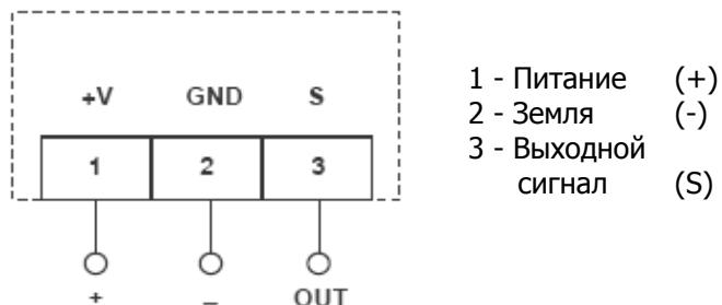
Рис2. Схема подключения
