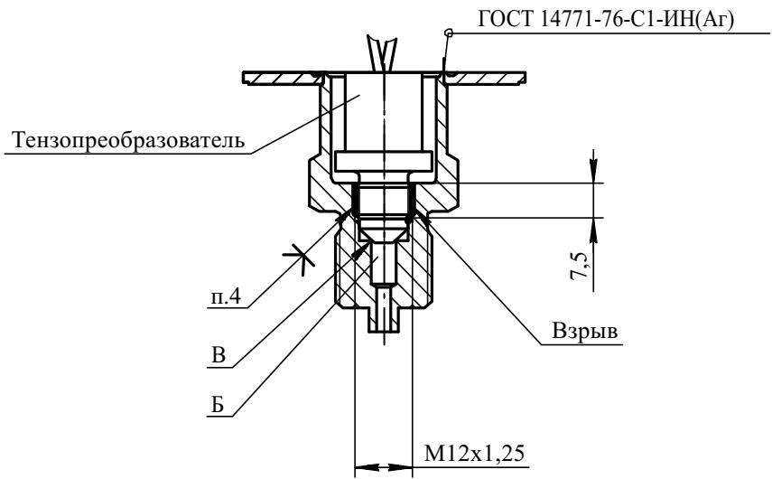
1. Шов испытан на прочность давлением 1,0 МПа. Разрушение не допускается.
