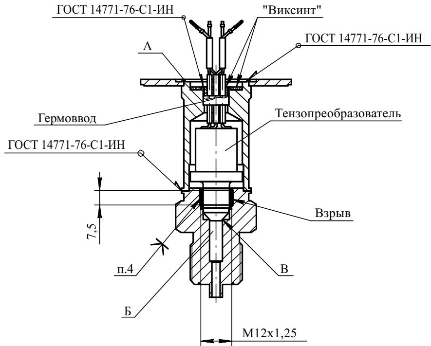
1. Шов А испытан на прочность давлением 1,0 МПа. Разрушение не допускается.
