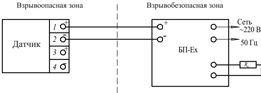
БП-Ex - искробезопасный блок питания
