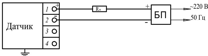
Рисунок Б.2 - Схема электрических соединений датчика
