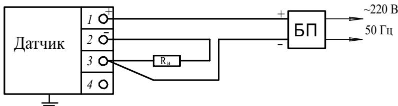
Рисунок Б.3 - Схема электрических соединений датчика
