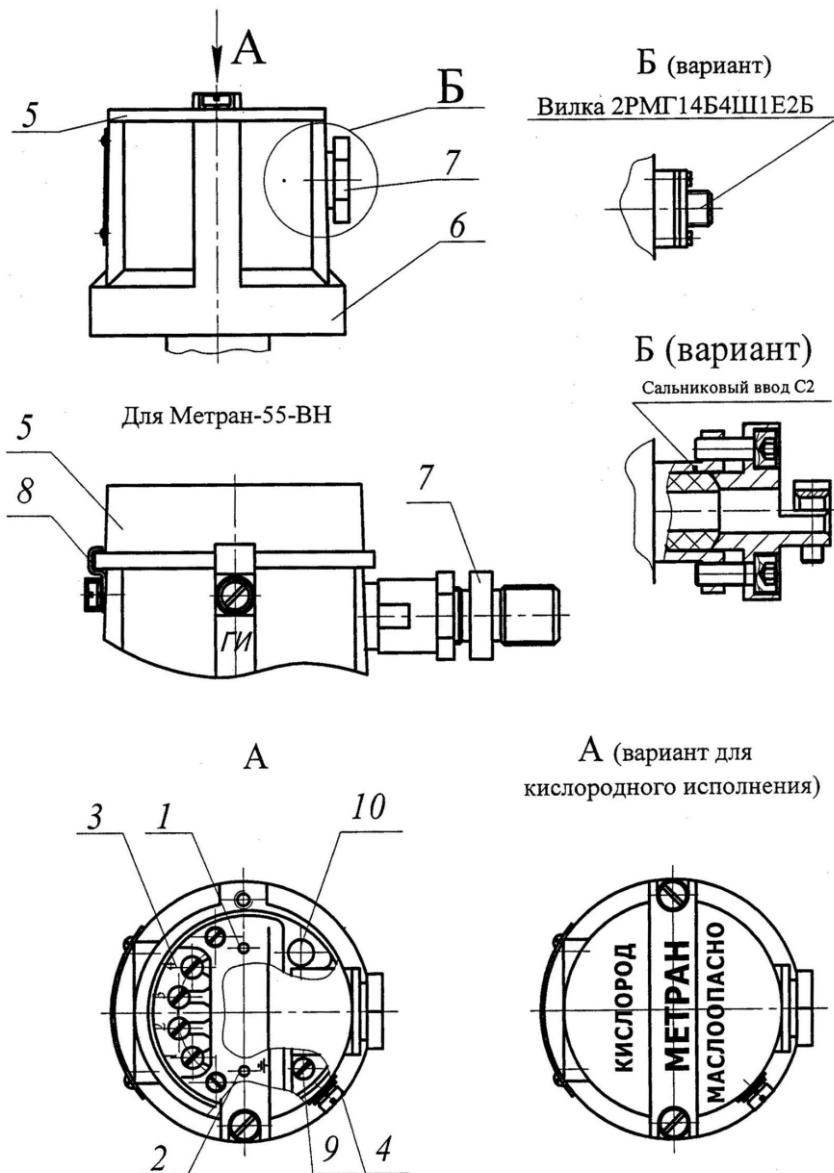
Рисунок 2 - Электронный преобразователь
