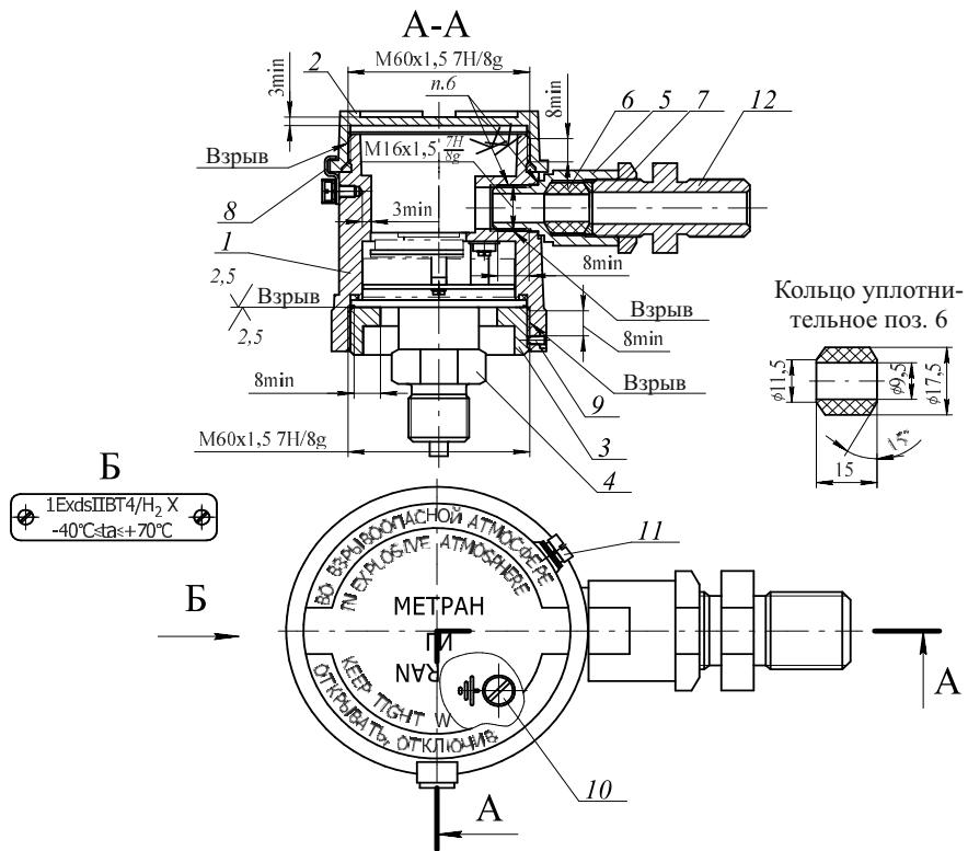
1-корпус; 2-крышка; 3, 7-гайка; 4-преобразователь давления; 5, 12-штуцер; 6-кольцо; 8-скоба; 9-винт; 10, 11-внутренний и наружный винты заземления.
