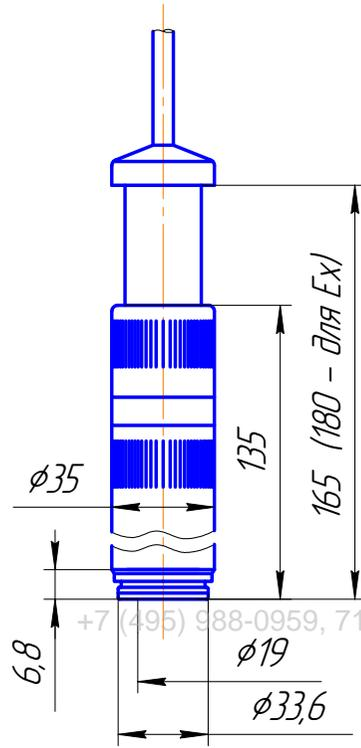
Рисунок В.19 – Габаритные и присоединительные размеры датчика Метран-55-ЛМП 308
