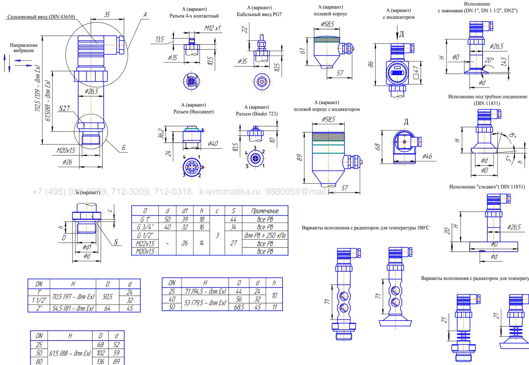
Рисунок В.14 – Габаритные и присоединительные размеры датчика Метран-55-ДМК 331П
