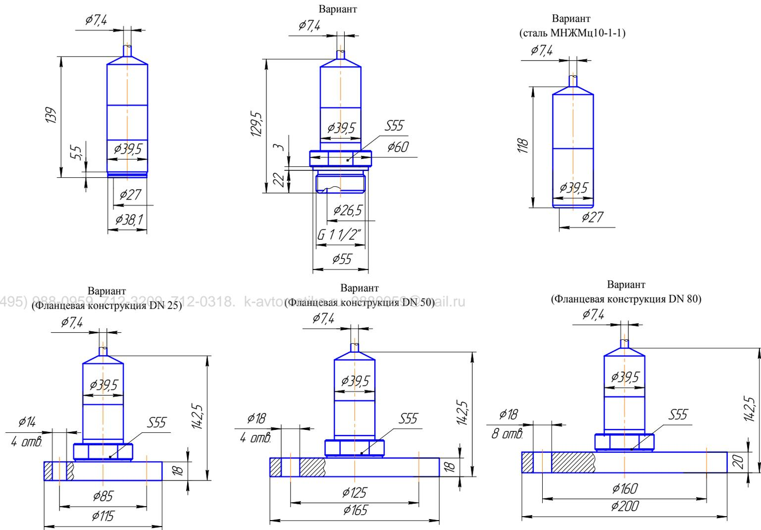
Рисунок В.22 – Габаритные и присоединительные размеры датчика Метран-55-ЛМК 457
