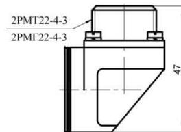
с разъемом 2PMT22-4-3 (P2), 2PMTГ22-4-3 (P5)
