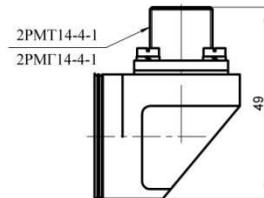
с разъемом 2PMT14-4-1 (P3), 2PMTГ14-4-1 (P4)
