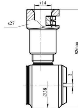
с угловым металлическим (УММ) сальниковым вводом и гайкой под металлорукав
