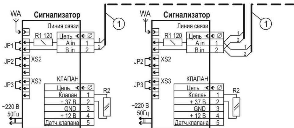
1 – кабель с витой парой, например, UTP-1x2x0,5 Cat 5e (для проводного способа связи);
