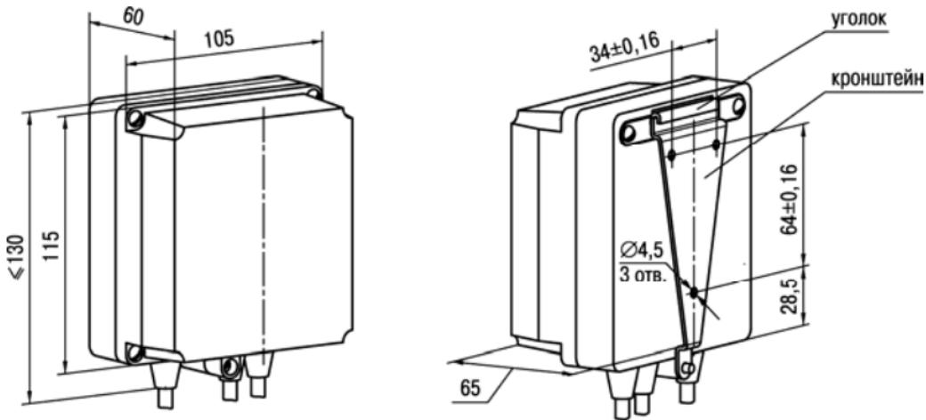
Рисунок А.1 - Габаритный чертеж
