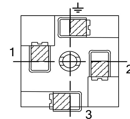
Расположение контактов на розетке разъема со стороны винтового закрепления проводников (Разъем в соответствии DIN 43650C серия GDS с 4 контактами).
