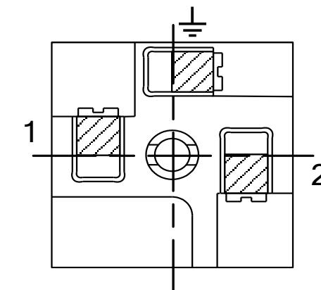
Расположение контактов на розетке разъема со стороны винтового закрепления проводников (Разъем в соответствии DIN 43650C серия GDS с 3 контактами).
