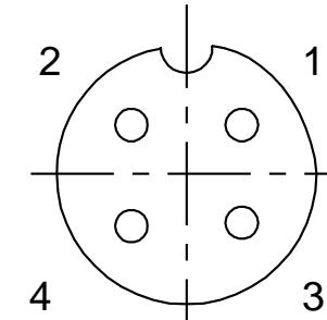
Расположение контактов на розетке со стороны пайки.(Разъем PC4).
