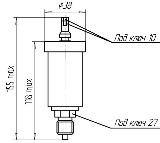
Рис. 2.1 Преобразователь давления ПДТВХ-1 с разъемом РС4
