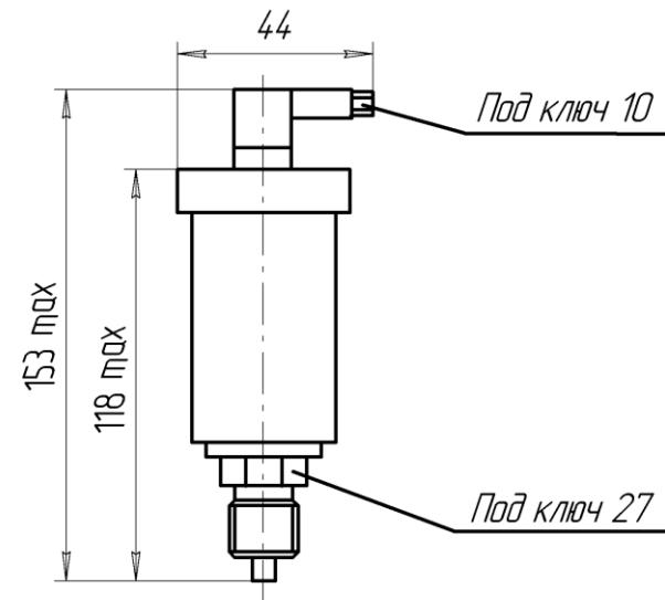
Рис. 2.2 Преобразователь давления ПДТВХ-1 с разъемом по DIN 43650.
