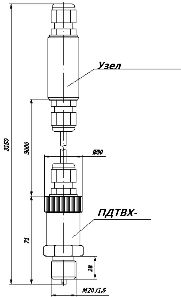
Рис. 1 Преобразователь избыточного давления ПД ТВХ-1-04
