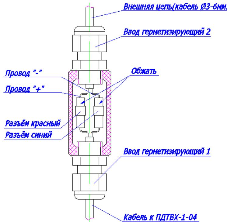
Рис. 2 Узел соединительный
