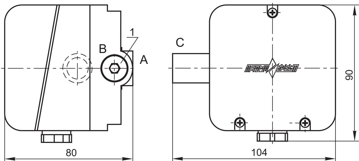
Рис. 22-3. Габаритные размеры датчиков-реле вакуумметрического давления (тяги) типа ДРД-Т
