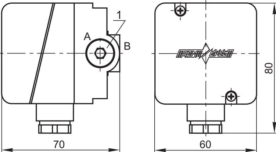
Рис. 22-1. Габаритные размеры датчиков-реле давления типа ДРД
