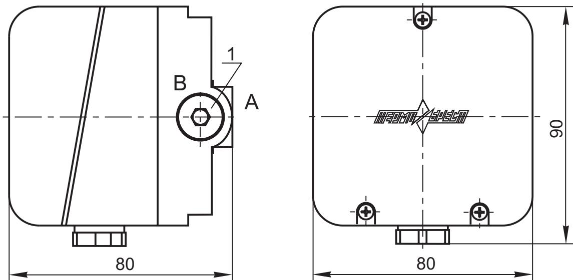
Рис. 22-2. Габаритные размеры датчиков-реле избыточного давления (напора) типа ДРД-Н
