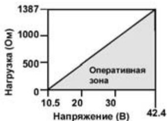
Для обеспечения передачи данных по протоколу HART минимальное сопротивление контура должно быть не менее 250 Ом.
