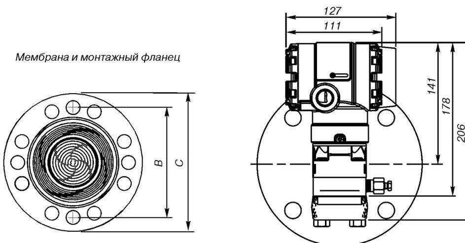
Рис.4. Датчик давления модели 2051L для измерения уровня.
