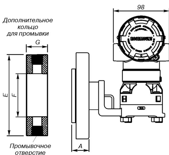
Рис.2. Датчик давления модели 2051L с фланцем заподлицо.
