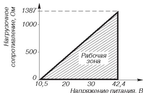
Рис. 1. Выходной сигнал 4-20 мА.
