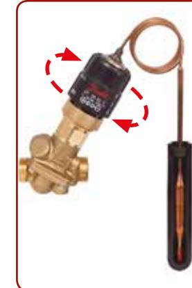
Установить термоэлемент QT на клапан AB-QM вручную, без использования инструментов. Максимальный крутящий момент не должен превышать 5 Н·м.
