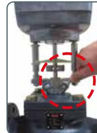
2.4. Соединить штоки клапана и электропривода, используя 4-мм шестигранный ключ (усилие затяжки 3–5 Н · м).
