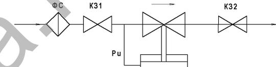
В) РР - сборка «НО» - регулятор расхода; регулирование перепада давлений
