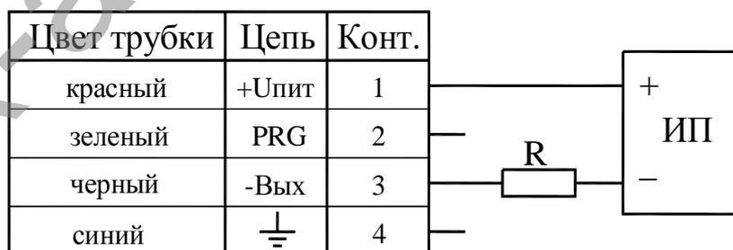
Выходы кабеля маркированы цветными трубками
