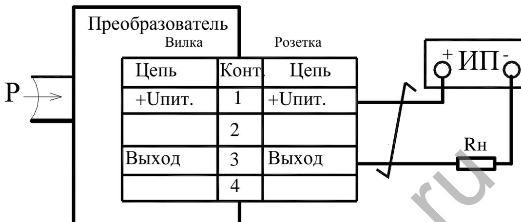
Рисунок Б.1 – Схема подключения преобразователей общепромышленного исполнения
