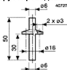
С каждым выключателем давления поставляются два трубопроводных адаптера
