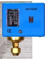
Реле (датчики) давления РД- 2-Х могут применяться для регулирования давления жидких и газообразных сред, неагрессивных по отношению к материалам внутренней системы реле давления. Для коммутации выходе реле давления имеется переключающий контакт (1SPDT) со следующим характеристиками (15A 110/220VAC; 10A 24VDC).
