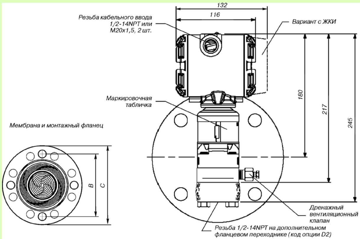
Рис. 12. Преобразователь 3051SAL.
