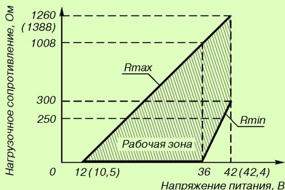
Для работы по HART-протоколу  $R_{min}=250$  Ом
