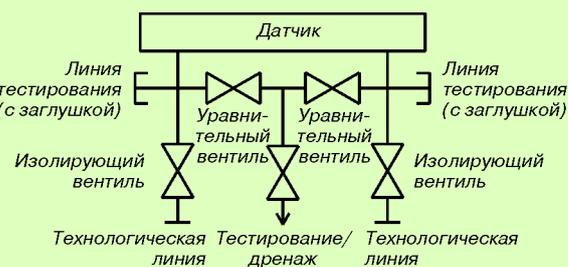
**Рис. 11. 5-вентильный блок для измерений природного газа.**
