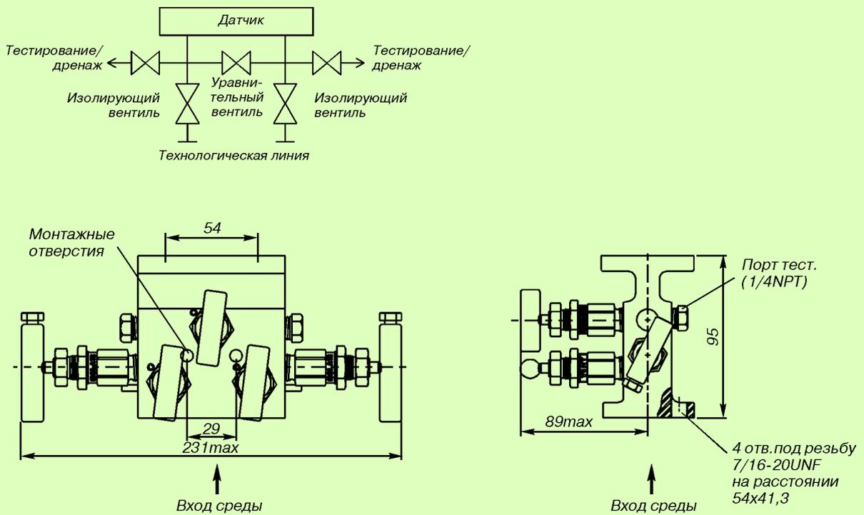
Рис.6. 5-вентильный блок 304RT62F, фланцевое соединение с процессом.
