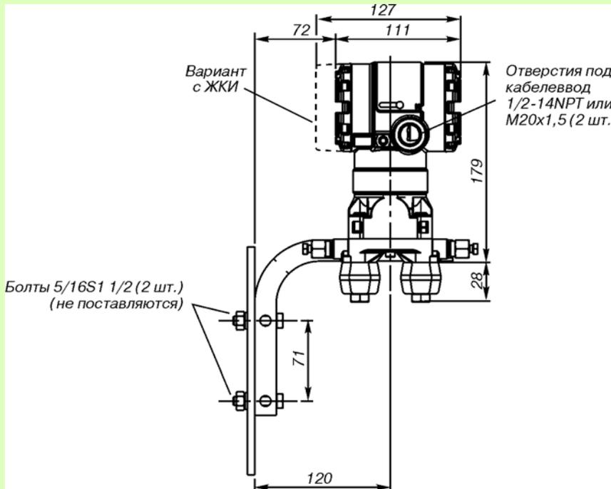
**Рис.4. Преобразователь давления модели 2051С с фланцем Sorplanar с дополнительным кронштейном (В4) для монтажа на 2-дюймовой трубе или панели.**
