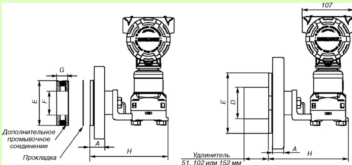
Рис.10. Конфигурация преобразователя 3051SAL с фланцевой разделительной мембраной и возможностью промывки (размеры см.табл.14).
