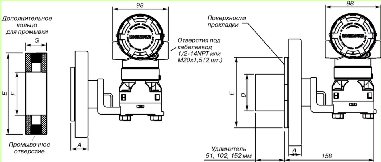
Рис.7. Преобразователь давления модели 2051L с фланцем заподлицо.
