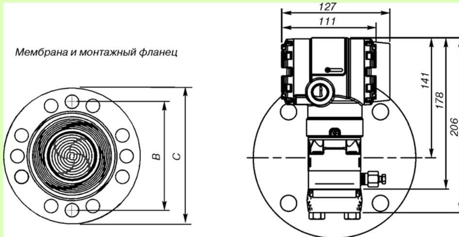
Рис.9. Преобразователь давления модели 2051L для измерения уровня.
