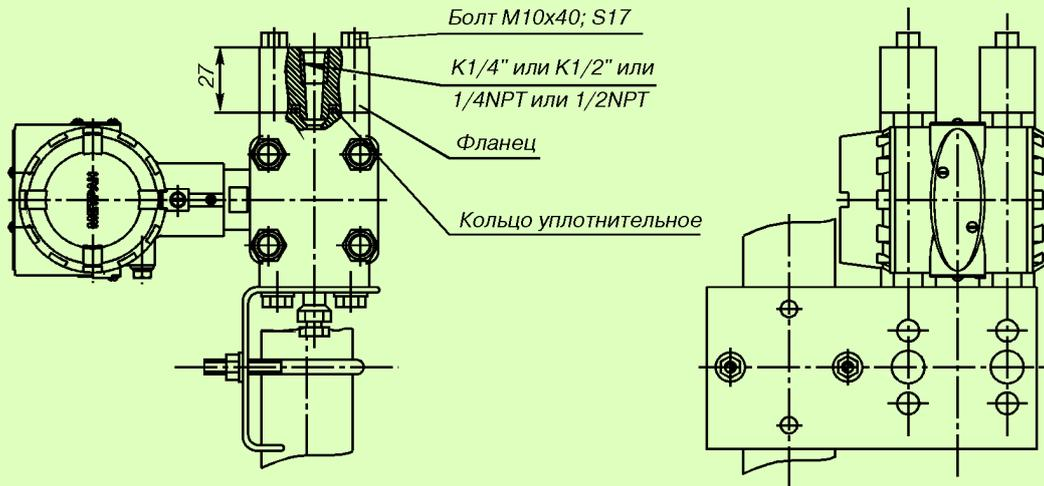
Рис.30. Датчики мод. 150CD с установленными монтажными фланцами с резьбовым отверстием К1/4" (код D1), или К1/2" (код D2), или 1/4NPT (код D3), или 1/2NPT (код D4) и монтажным кронштейном для установки на трубе  $\phi 50$  мм (код В1).
