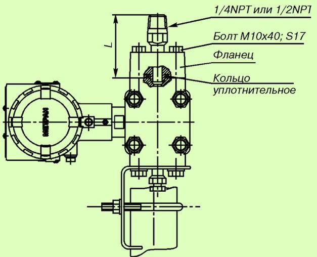
Рис. 29. Датчики мод. 150CD с установленными монтажными фланцами со штуцером 1/4NPT (код D7) или 1/2NPT (код D8) и монтажным кронштейном для установки на трубе  $\phi 50$  мм (код B1).
