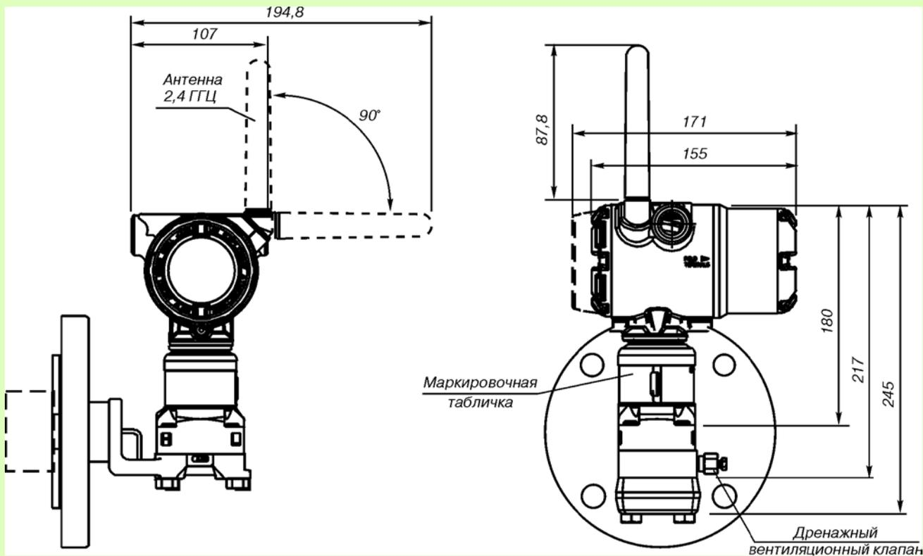
Рис. 15. Беспроводной преобразователь 3051SAL.
