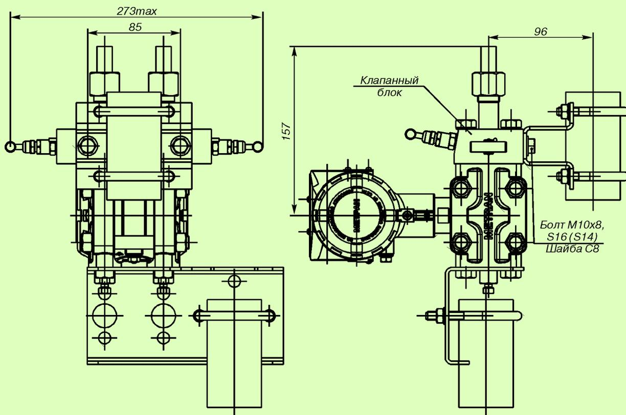
**Рис.22. Датчики мод. 150CD с установленным клапанным блоком (коды W1 или W2 или W3) и монтажным кронштейном для установки датчика на трубе ±50 мм (код В1).**
