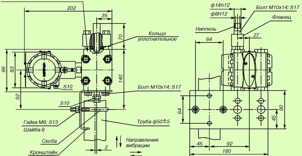
Рис.23. Датчики мод. 150CG с установленным ниппелем (код D6)
