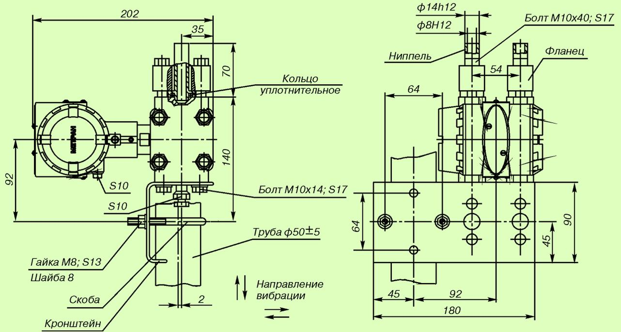
Рис. 17. Датчики мод. 150CD с установленными ниппелями (код D6) и монтажным кронштейном для установки на трубе  $\phi 50$  мм (код B1).
