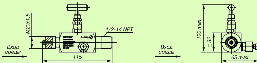
Рис. 14. 1-вентильный блок модели 0106 М Т 1 с кодом соединения с процессом С и типом соединения с датчиком А.
