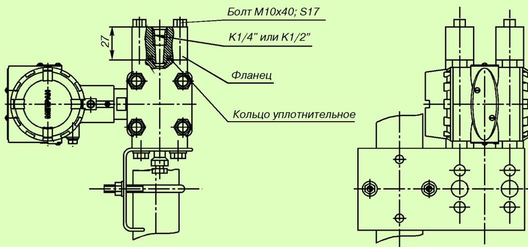
Рис. 19. Датчики мод. 150CD с установленными монтажными фланцами с резьбовым отверстием К1/4" (код D1), или К1/2" (код D2) и монтажным кронштейном для установки на трубе  $\phi 50$  мм (код В1).
