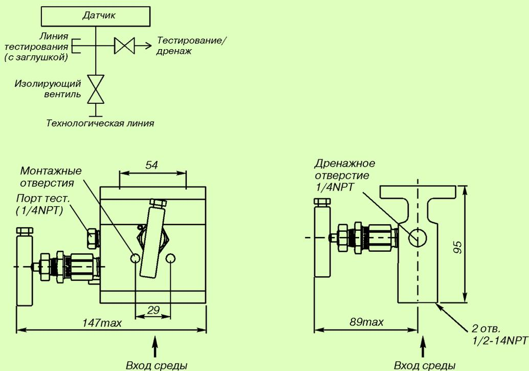
Рис.3. 2-вентильный блок 304RT22В, резьбовое соединение с процессом.
