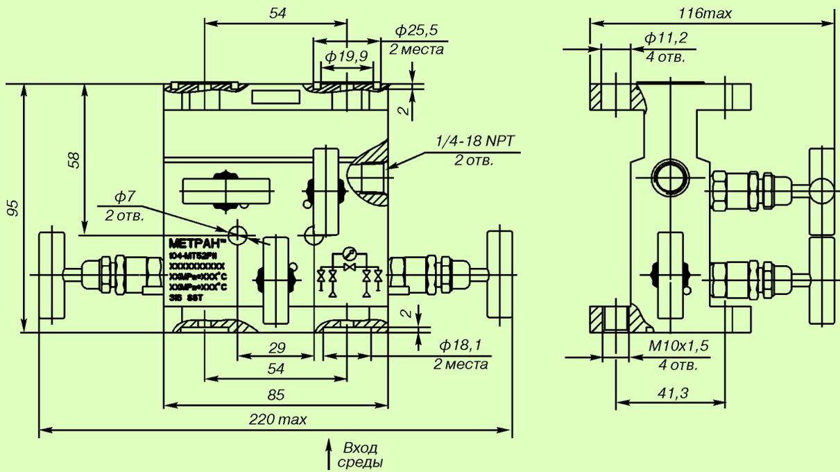
Рис.5. 5-вентильный блок модели 0104 М Т 5 с кодом подключения среды Ф.
