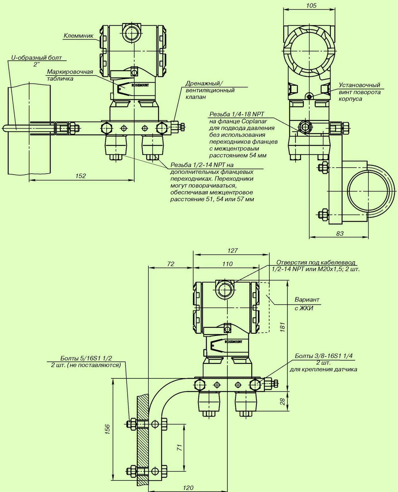
Рис.7. Датчик давления модели 3051C с фланцем Corplanar с дополнительным кронштейном (B4) для монтажа на 2-дюймовой трубе или панели.
