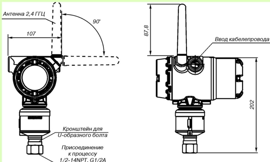
Рис. 14. Беспроводной преобразователь 3051S штуцерного исполнения.
