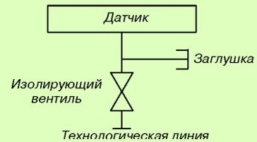
**Рис. 14. 1-вентильный (запорно-стравливающий) блок.**
