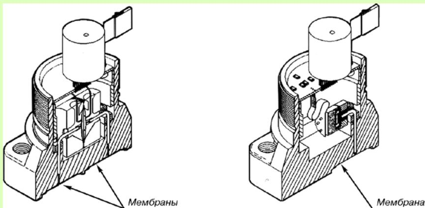
**Сенсор на базе емкостной ячейки
