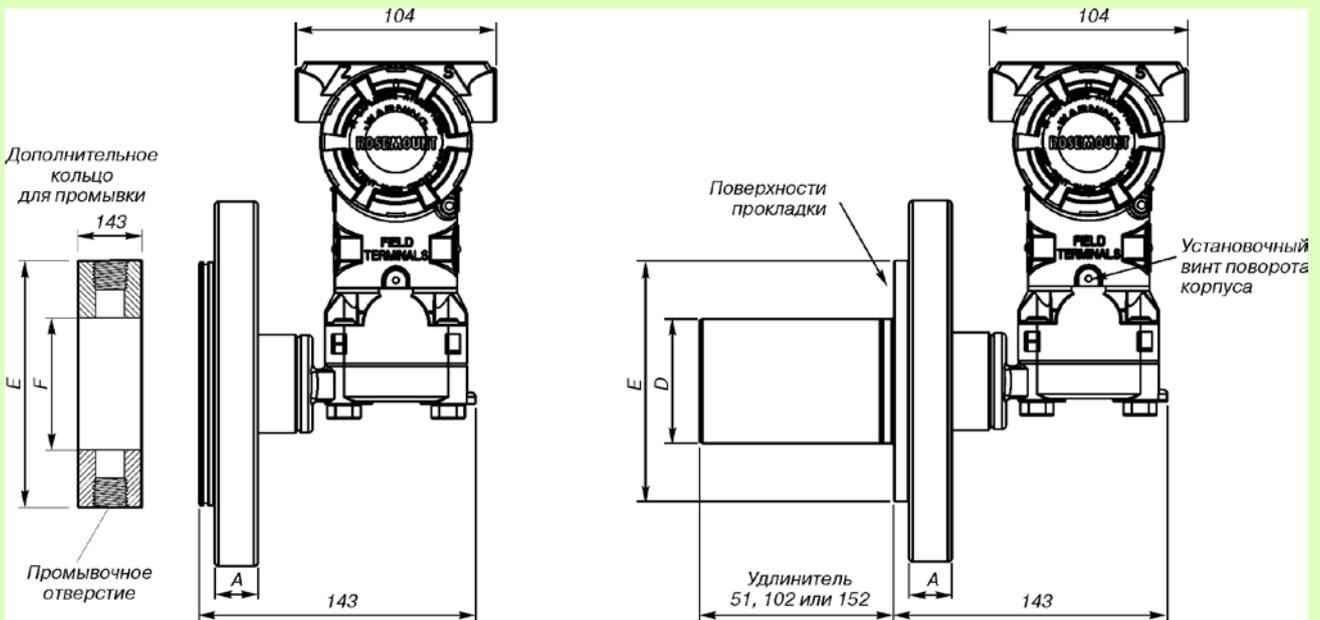
Рис. 12. Конфигурация датчика 3051L с фланцем заподлицо.
