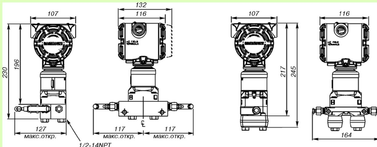
**Рис.3. Корпус PlantWeb на платформе Coplanar Super-Module с интегральным клапанным блоком 305 Coplanar.**
