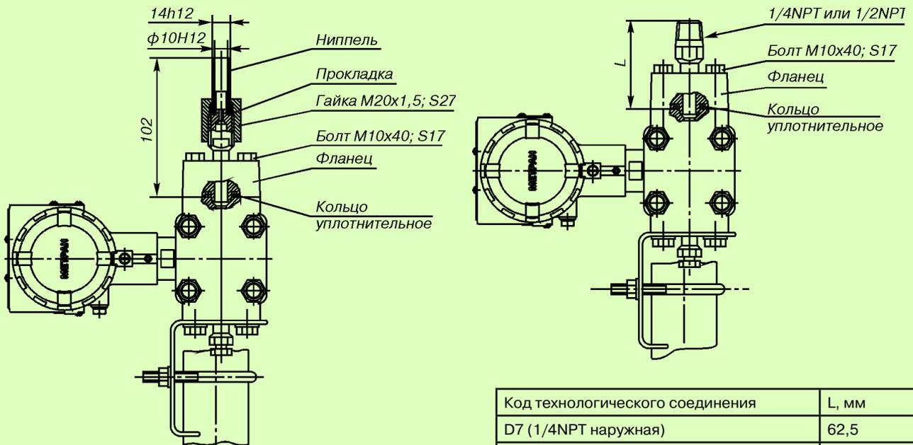
Рис. 28. Датчики мод. 150CD с установленными ниппелями под накидные гайки M20x1,5 (код D5) и монтажным кронштейном для установки на трубе  $\phi 50$  мм (код B1).
