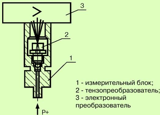
Датчик давления Метран-55 состоит из преобразователя давления - измерительного блока (ИБ) и электронного преобразователя (ЭП).
