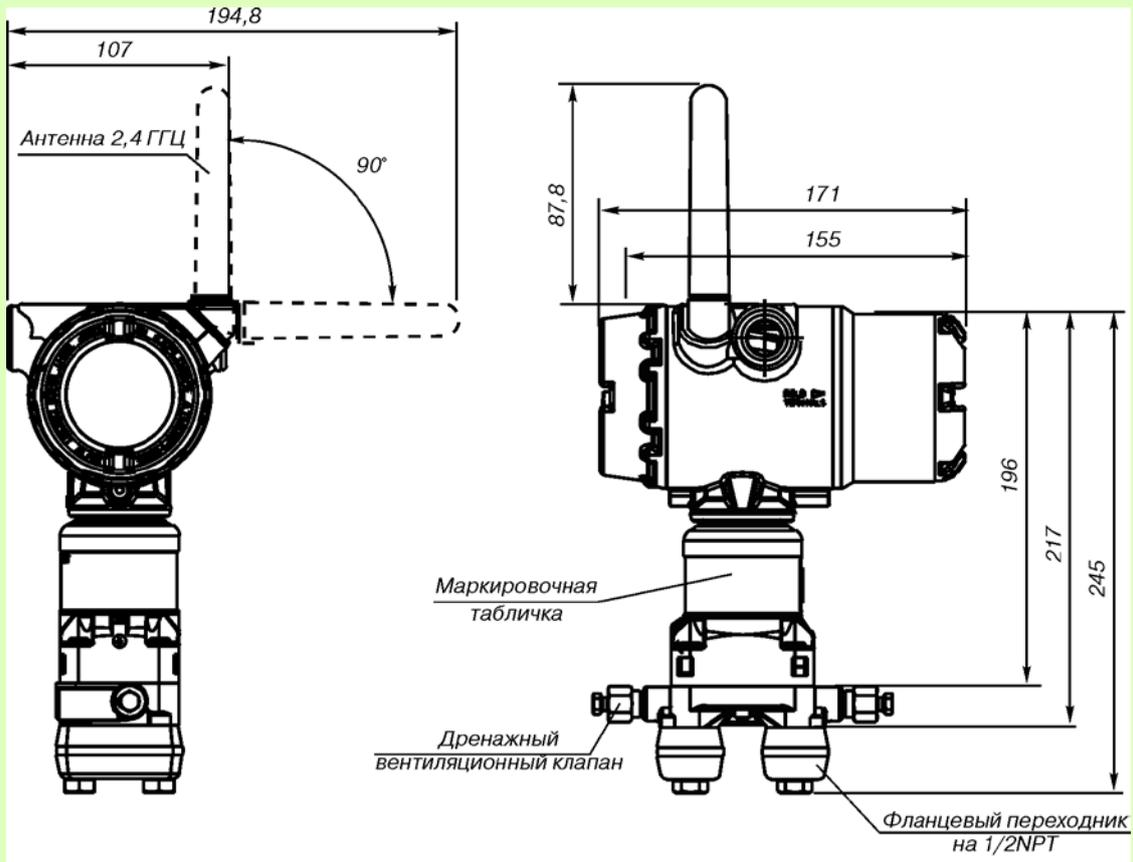
Рис. 13. Беспроводной преобразователь 3051S с фланцем Corlanar®.
