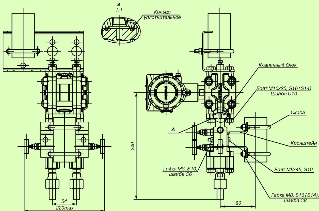
**Рис.21. Датчики мод. 150CD с установленным клапанным блоком (коды Т1 или Т2 или Т3) и монтажным кронштейном для установки датчика на трубе ±50 мм (код В1).**
