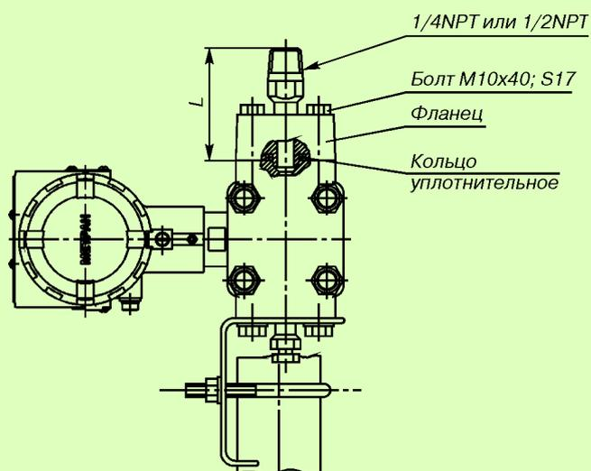
Рис.25. Датчики мод. 150CG с установленным монтажным фланцем со штуцером 1/4NPT (код D7) или 1/2NPT (код D8) и монтажным кронштейном для установки на трубе  $\phi 50$  мм (код B1).
