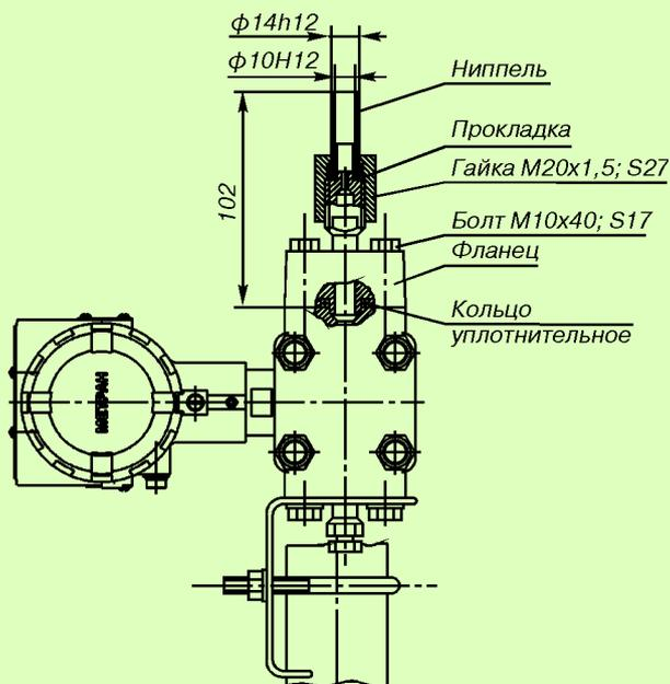
Рис. 15. Датчики мод. 150CG с установленным ниппелем под накладную гайку M20x1,5 (код D5) и монтажным кронштейном для установки на трубе  $\phi 50$  мм (код B1).
