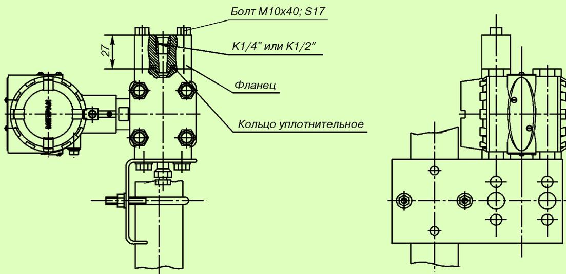
Рис. 16. Датчики мод. 150CG с установленным монтажным фланцем с резьбовым отверстием K1/4" (код D1) или K1/2" (код D2) и монтажным кронштейном для установки на трубе  $\phi 50$  мм (код B1).
