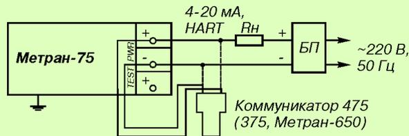
**Рис.3. Выходной сигнал 4-20 мА (2-х-проводная линия связи).**
