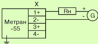
Вариант подключения нагрузки для датчика
