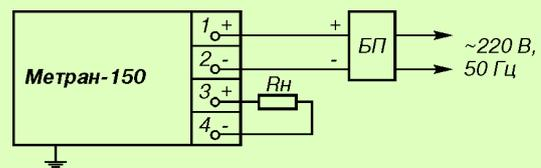
**Рис. 7. Выходной сигнал 0-5 мА (4-х-проводная линия связи).**
