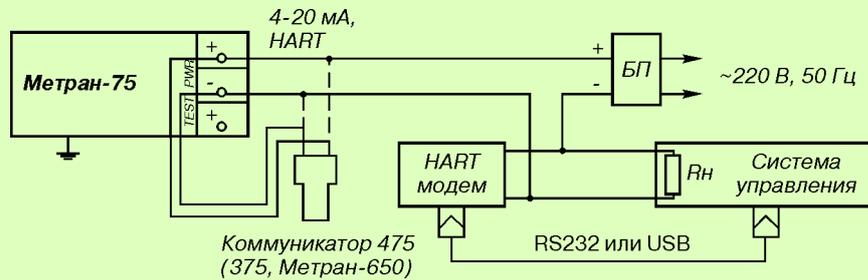
**Рис.4. Вариант включения датчика с HART- модемом или HART- коммуникатором.**
