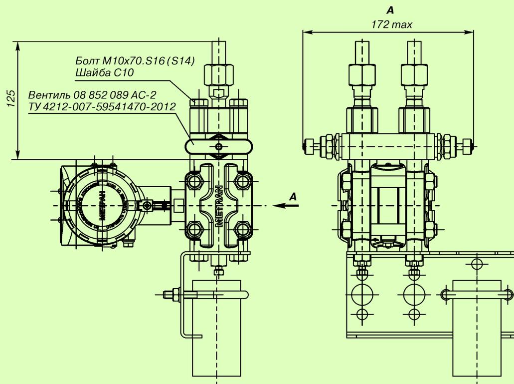
**Рис.25. Датчики мод. 150СD с установленным вентилем 08 852 089 кода V1.**
