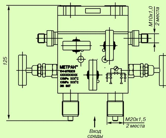
Рис.7. 5-вентильный блок модели 0104 М Т 5 с кодом соединения с процессом С.
