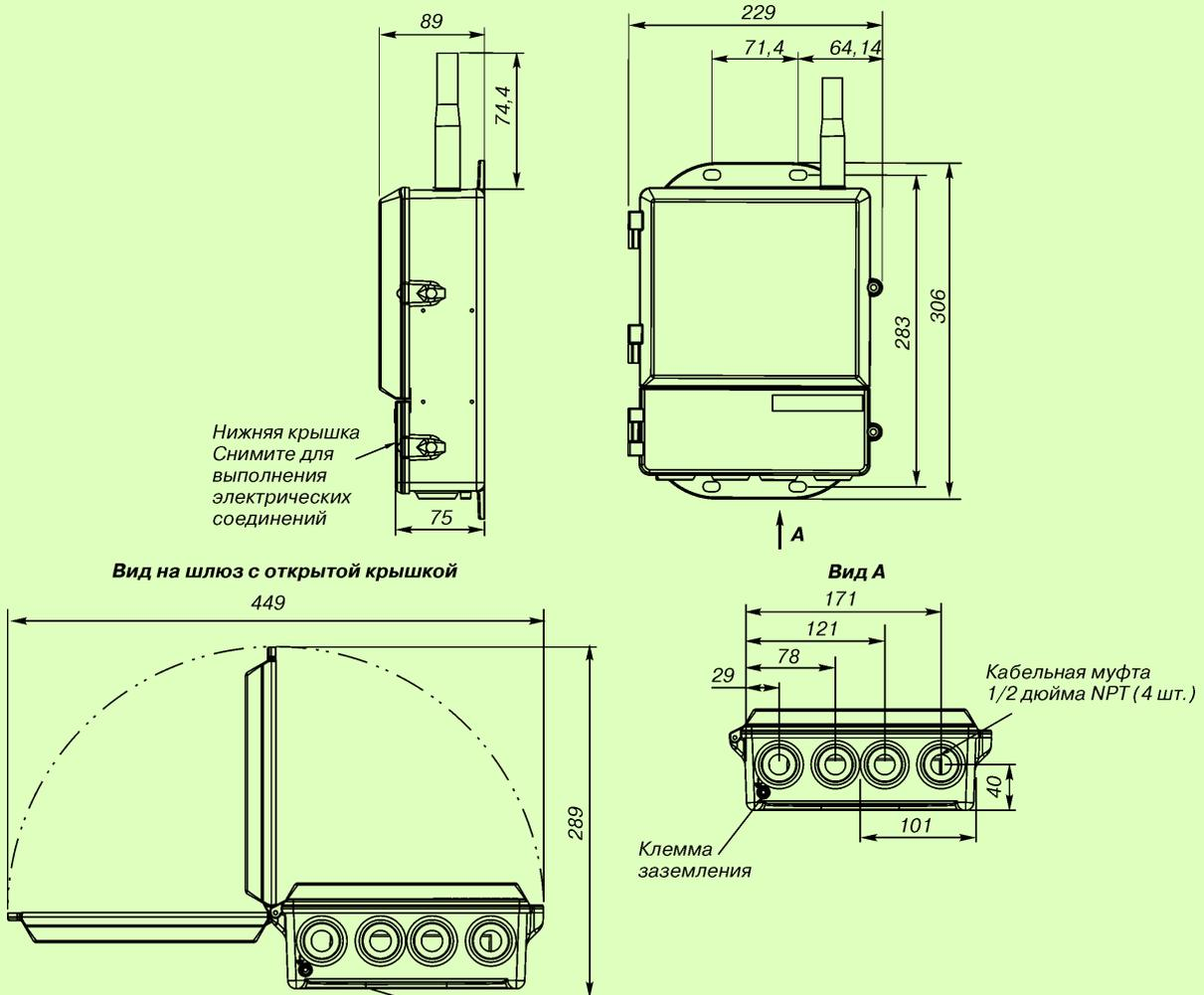
Рис.7. Беспроводной шлюз 1420.
