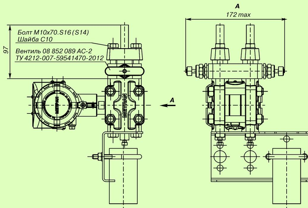
**Рис.26. Датчики мод. 150СD с установленным вентилем 08 852 089 кода V2.**
