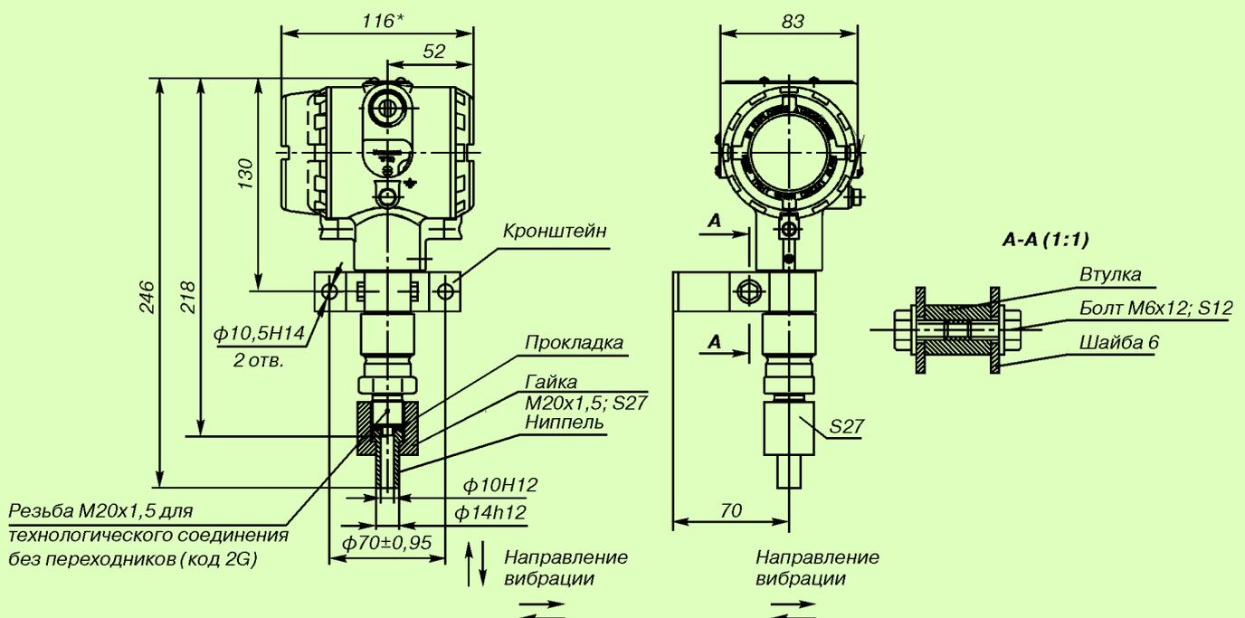
Рис.32. Датчики мод. 150TG, ТА с установленным ниппелем (код 2F) и монтажным кронштейном (код В1).
