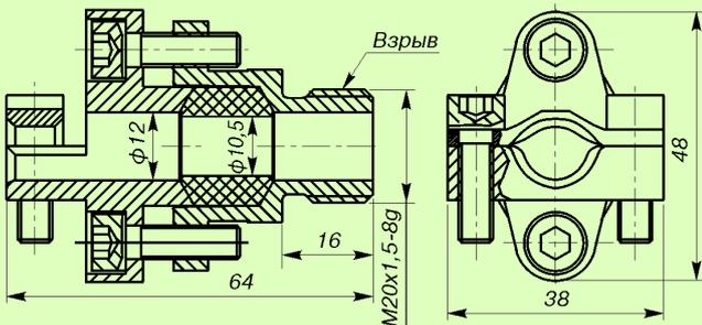
Кабельный ввод для монтажа бронированного кабеля (БК)<sup>1)</sup>.
