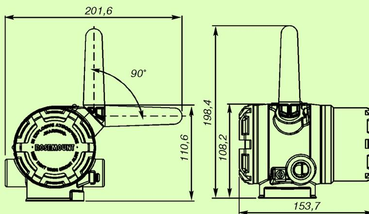
Рис.5. Корпус беспроводного преобразователя Rosemount 248.
