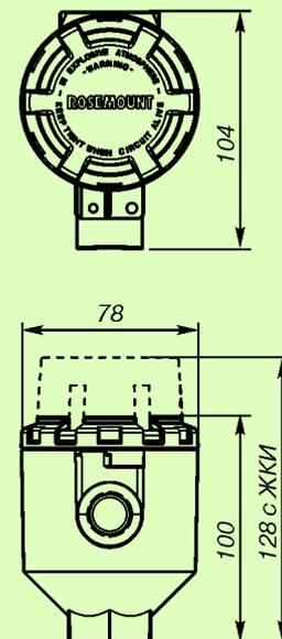
**Рис. 9. Соединительная головка исполнения DIN
