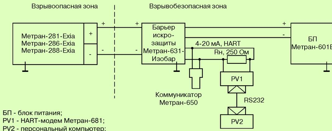
Рис.28. Метран-281-Exia, -286-Exia, -288-Exia с барьером искрозащиты с гальванической развязкой цепи питания и информационной цепи.
