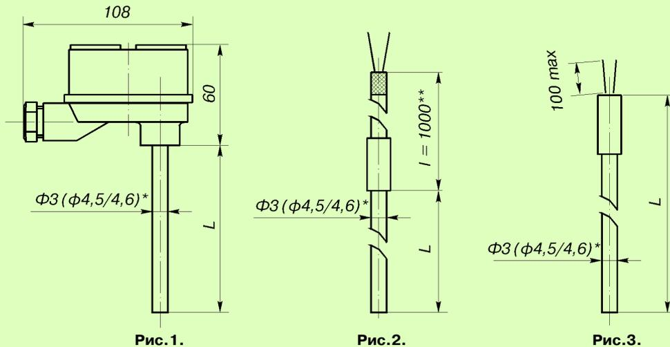
\* Размеры указаны для термопреобразователей, изготовленных из термопарного кабеля с двумя чувствительными элементами.
