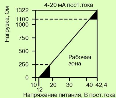
Рис.2. Ограничение нагрузки.
