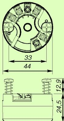
Измерительный преобразователь Rosemount 248 (монтаж на рейке)
