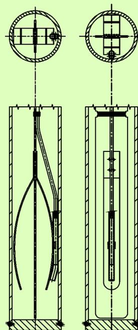
Рис. 4. Исполнение с пластинчатой пружиной.
