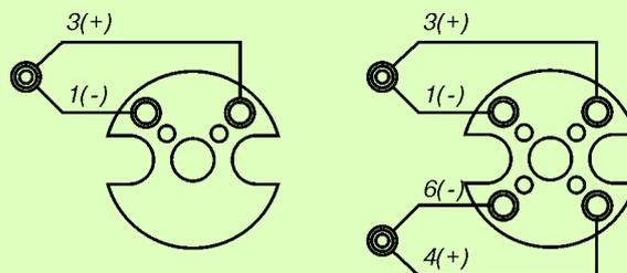
Рис.3. Конфигурация выводов ТП Rosemount 0185 - клеммный блок.
