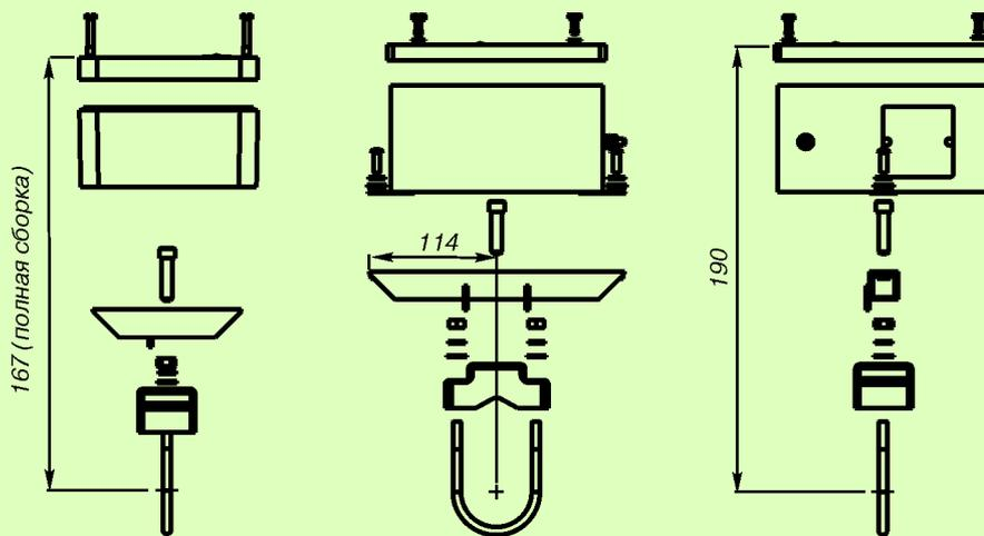
Рис.7. Дополнительная соединительная коробка из нержавеющей стали (код опции JS).
