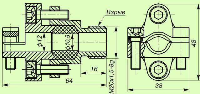
**Кабельный ввод для монтажа бронированного кабеля (БК) <sup>2)</sup>.**
