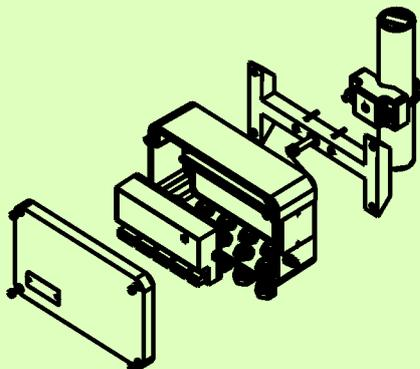
Рис.8. Дополнительная соединительная коробка из алюминия/пластика для монтажа на вертикальной трубе.
