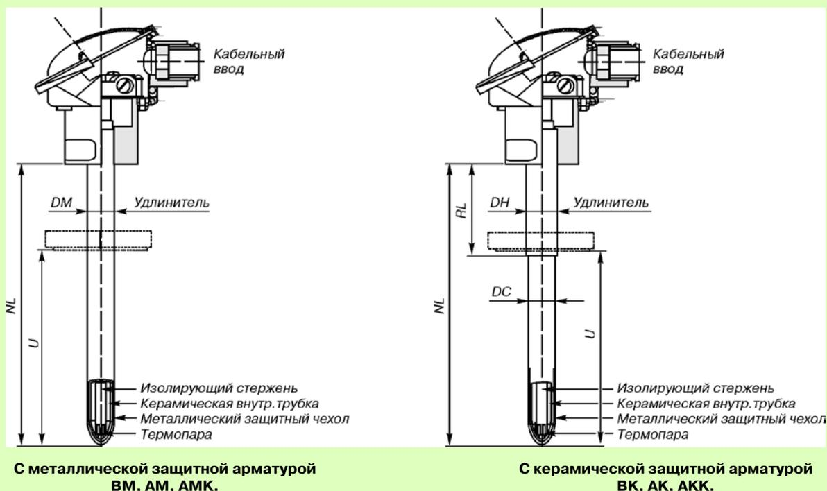
Рис. 1. Конструктивное исполнение.
