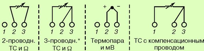
**Рис. 10. Схема подключения ПП к преобразователю Rosemount 848T.**
