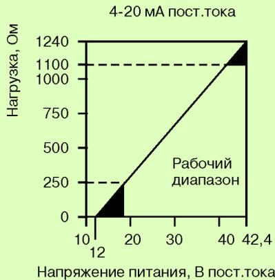
**Рис. 1. Ограничение нагрузки.**
