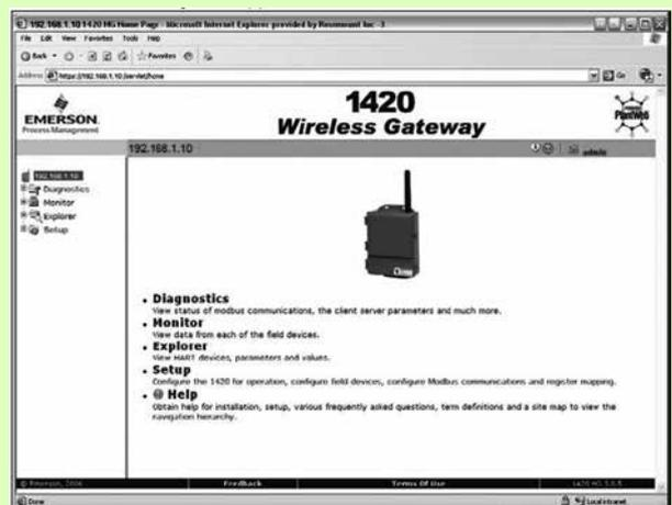
Рис.5. Окно беспроводного шлюза 1420 в интернет браузере.
