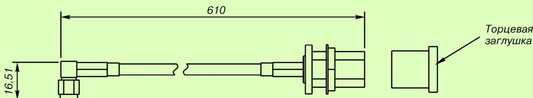
Рис. 4. Габаритные размеры кабеля с адаптером типа SMA-to-N.
